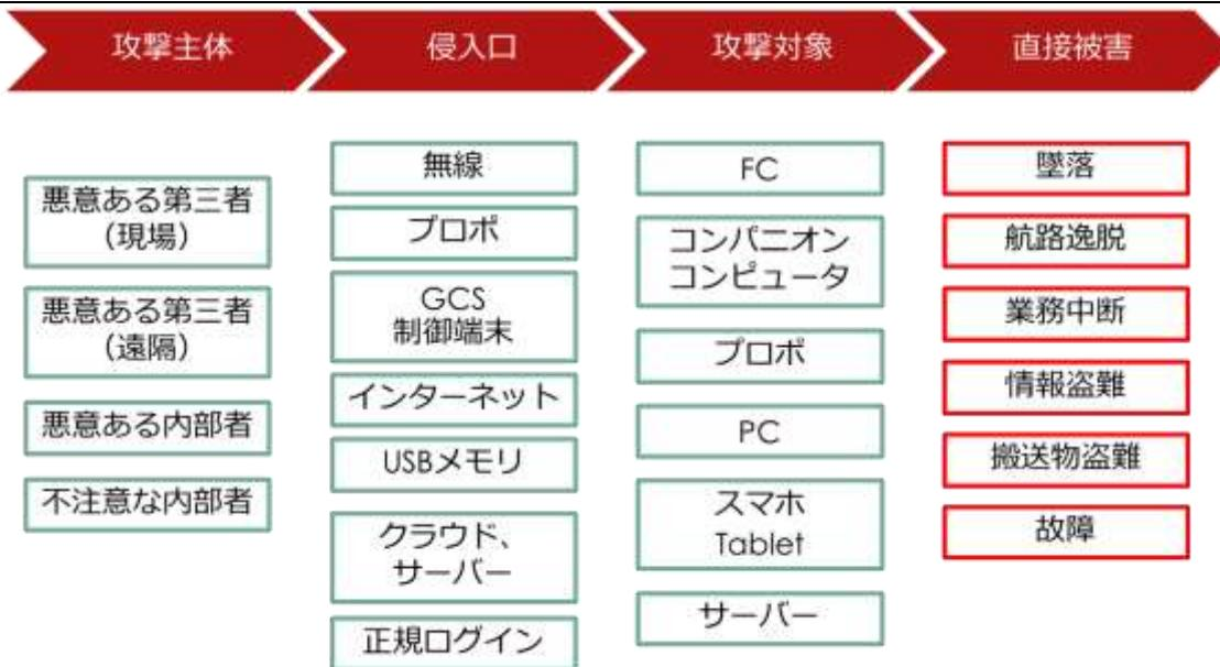
図 6：ドローンのリスクの侵入モデルと直接被害
